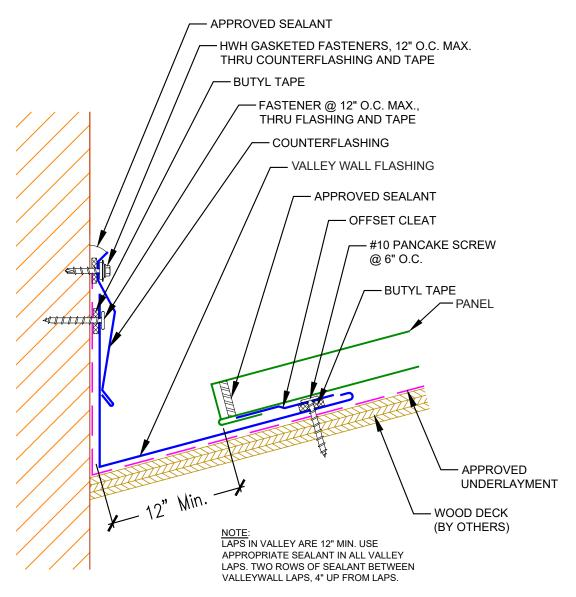
\*\* SUFFICIENT SLOPE MUST BE PROVIDED FOR POSITIVE DRAINAGE
